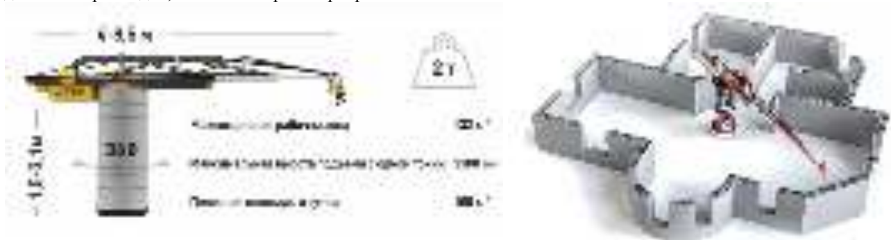
Рисунок 5. Телескопический строительный 3D-принтер
