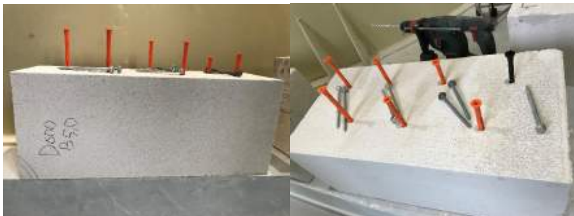
Фото 4. Подготовка к испытаниям на выдергивание анкеров
