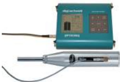
Рисунок 2. Общий вид прибора «Digi-Schmidt 2000»
